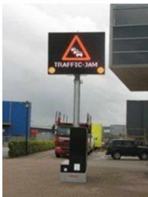
Figuur 16: voorbeeld van filewaarschuwingssysteem
